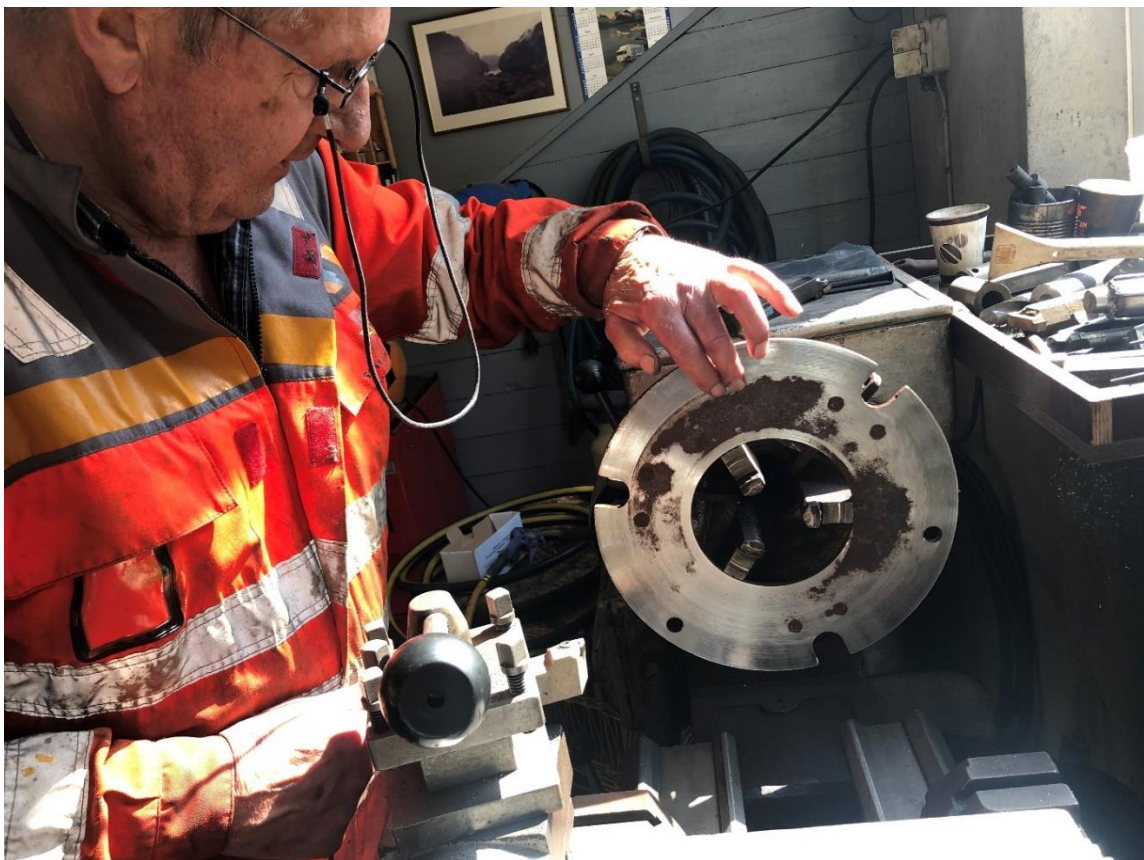
Kløtsjskiven var svært rustet og ble dreiet litt ned for å kunne gjenbrukes
