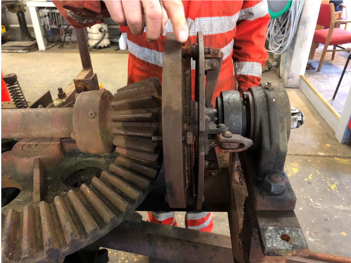
Klutsj før demontering
