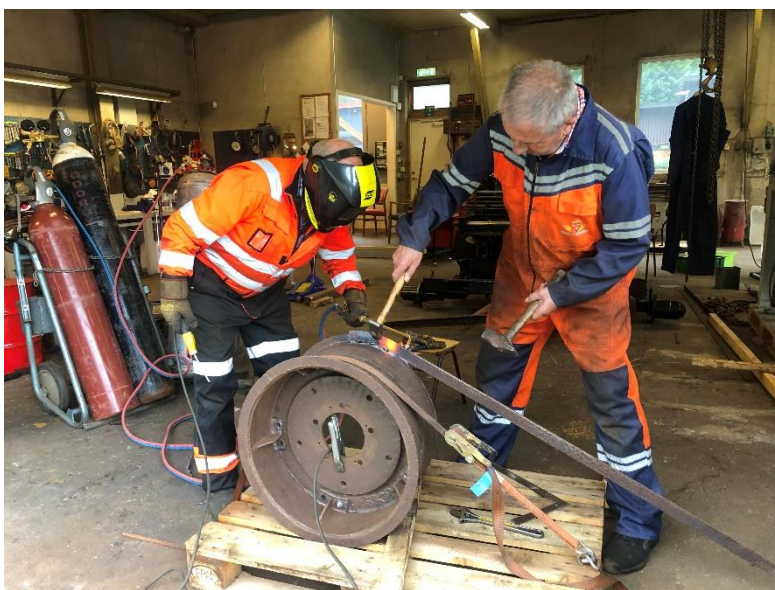
Felgene ble reparert ved å sveise og smi inn et nytt stykke. (Martin Nødland til venstre og Per Skårland til høyre)
