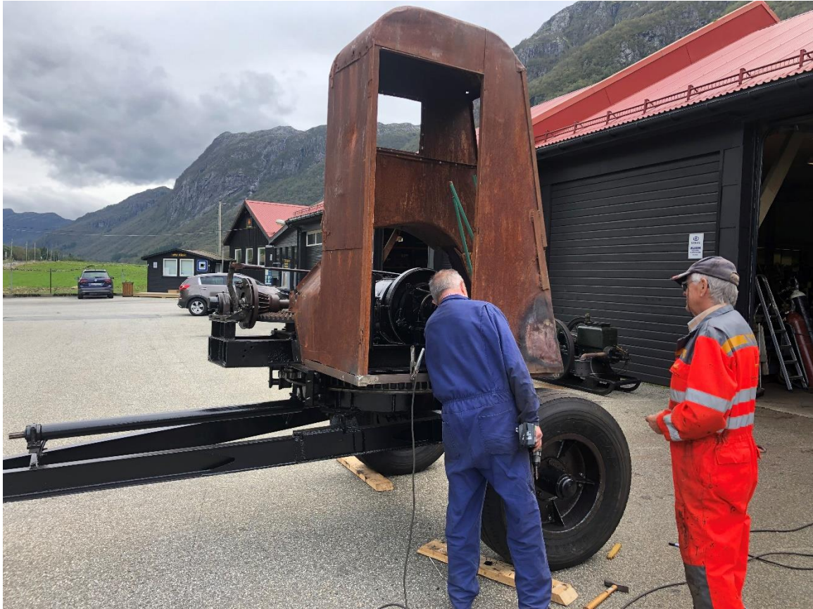
Hytta er rettet opp. Her arbeides det med å sveise inn nye plater. (Per Skårland til venstre og Kjell Navrestad til høyre)
